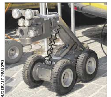
♦ Robot z kamerą, dzięki któremu można dokładnie obejrzeć stan rur kanalizacyjnych bez potrzeby ich rozkopywania
